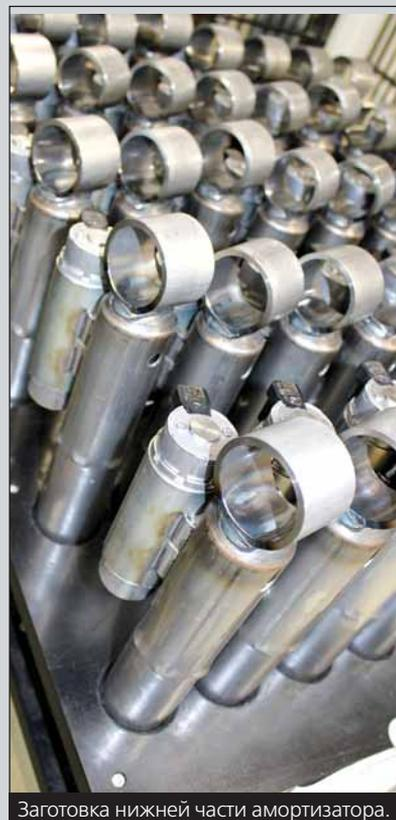
Заготовка нижней части амортизатора.
