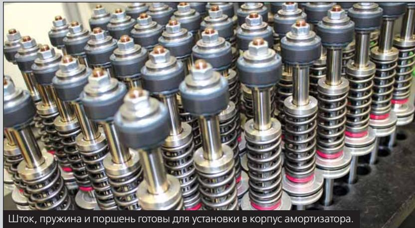
Шток, пружина и поршень готовы для установки в корпус амортизатора.
