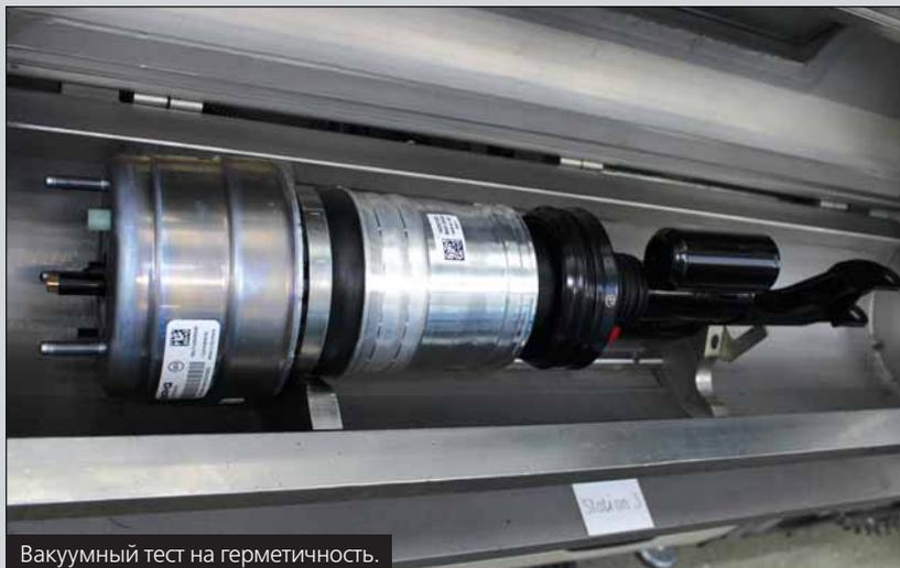
Вакуумный тест на герметичность.
