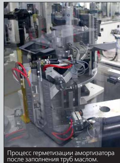
Процесс герметизации амортизатора после заполнения труб маслом.
