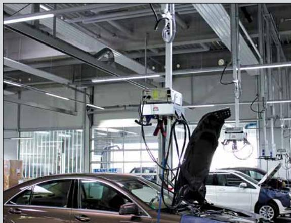
Специалисты компании Маха недавно представили новую версию компактного энергохаба E-BOX для станций техобслуживания. Многофункциональное устройство имеет три разъема с электропитанием и два подключения сжатого воздуха с предохранительными муфтами.
