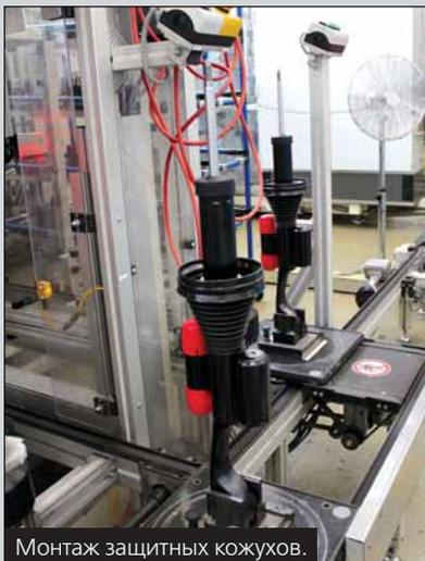
Монтаж защитных кожухов.
