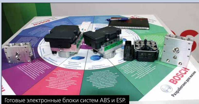
Готовые электронные блоки систем ABS и ESP.
