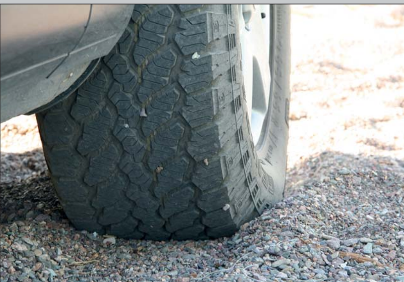
В месте посадки край диска защищен от сколов усиленным кольцом и выступающей боковой частью шины.
