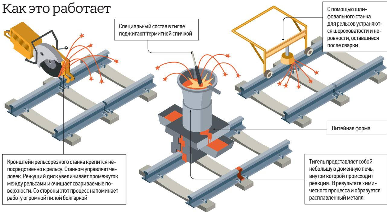
Кронштейн рельсорезного станка крепится непосредственно к рельсу. Станком управляет человек. Режущий диск увеличивает промежуток между рельсами и очищает свариваемые поверхности. Со стороны этот процесс напоминает работу огромной пилой болгаркой
